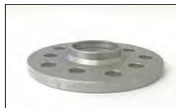
Artikel-Nr./Part-no. 2055571B: Radnabenlänge max. 12 mm. Felgeninnenfase mind. 4x45° Wheel hub length max. 12 mm. Inner bevel 4x45°.
