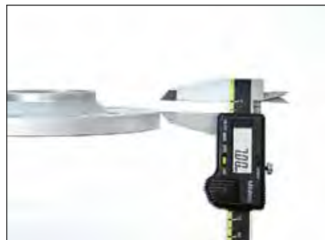
Darstellung Aussenfase 7x45°/Outer bevel 7x45°
