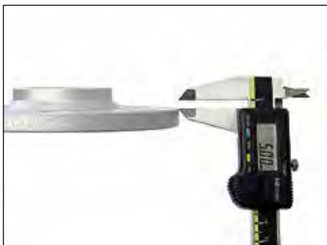
Darstellung Aussenfase 5x45°/Outer bevel 5x45°
