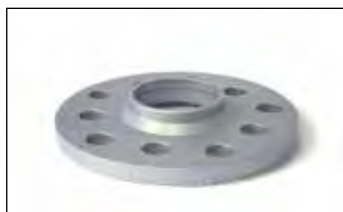
Artikel-Nr./Part-no. 20255570B: Radnabenlänge max. 13,5 mm. Felgeninnenfase mind. 5x45° Wheel hub length max. 13,5 mm. Inner bevel 5x45°.
