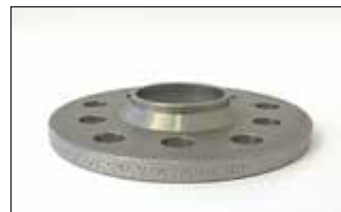
Artikel-Nr./Part-no. 2055571A: Radnabenlänge max. 15,5 mm. Felgeninnenfase mind. 6,5x45° Wheel hub length max. 15,5 mm. Inner bevel 6,5x45°.
